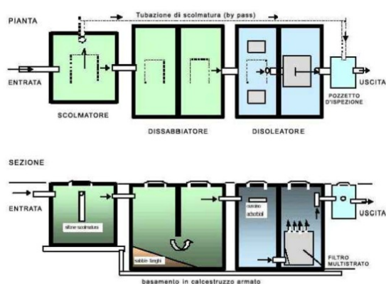
schema impianto di pretrattamento
