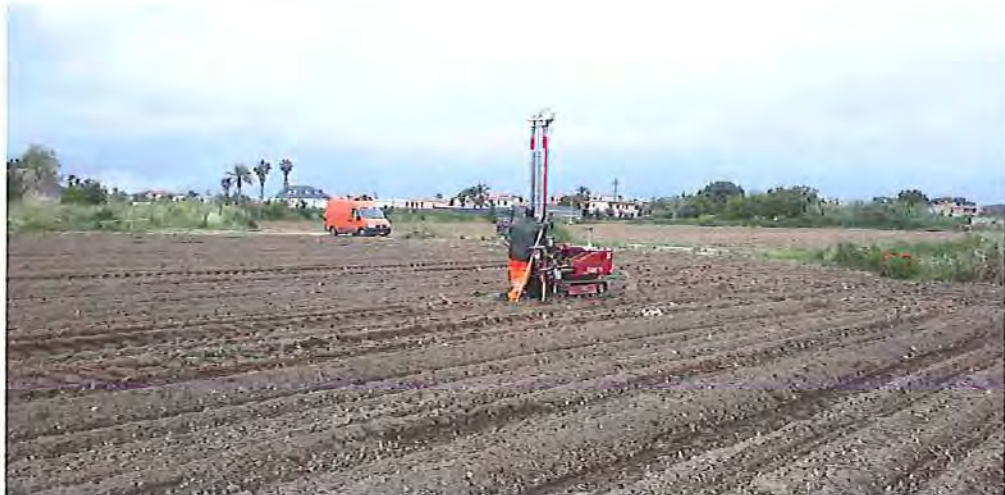
Penetrometrica statica n. 1
