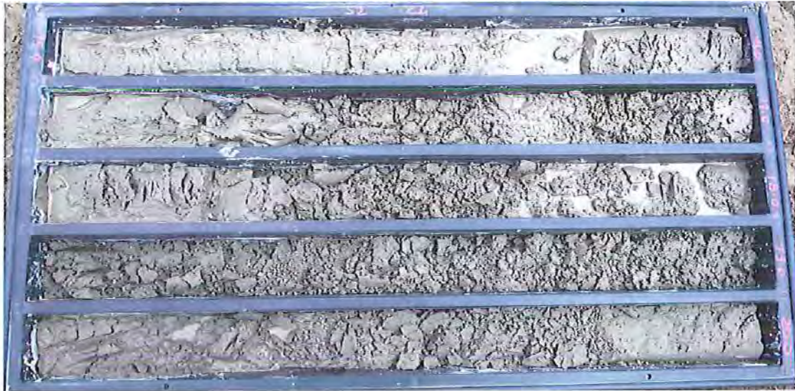
Sondaggio S2 cassetta 4 da 15.00 a 20.00
